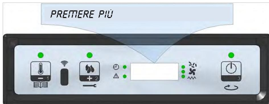
ventilatore fumi si accende alla massima velocità, la coclea si accende (led coclea acceso) e vi rimangono fino ad esaurimento del tempo indicato sul display (Figura 17a), oppure fino alla pressione del tasto P3.
