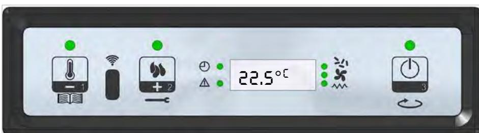
P2 (aumenta) è possibile modificarne il valore. Dopo circa 5 secondi il valore viene memorizzato ed il display ritorna alla normale visualizzazione, oppure per uscire premere P3. (Figura 8).
