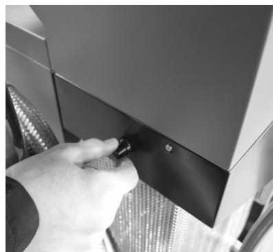
Figura 21: Dezarmarea protecției termice
