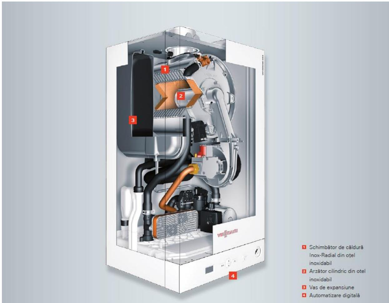
Cu o rezistență superioară împotriva coroziunii, centrala termică Viessmann Vitodens 050 de 24 kW are un consum maxim de gaz metan/ electricitate de 2,37 m<sup>3</sup>/h/ 97 W, fiind una dintre cele mai economice centrale termice de pe piață.
