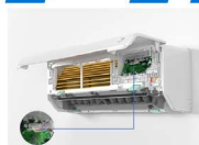
Desfaceti capacul cutiei electrice, deconectati bornele ventilatorului si ale deflectoarelor verticale
